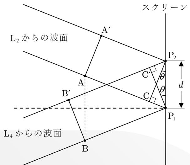
と等しくなければならない。点  $A'$  と点  $B'$  の光の経路差  $\Delta l$  は、 $\Delta l = \overline{B'P_2} - \overline{A'P_2}$  であるが、 $\overline{A'P_2} = \overline{AP_1} - \overline{CP_1}$ 、 $\overline{B'P_2} = \overline{BP_1} + \overline{C'P_2}$  であるから、
